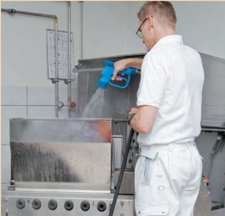
Nettoyage à l'eau de la trémie
