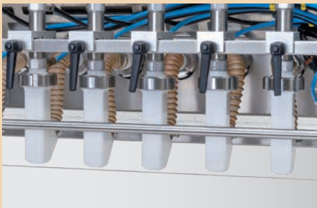
Dispositif d'obturation à buse pour les garnitures visqueuses et dispositif de coupe à fil pour les garnitures fibreuses
