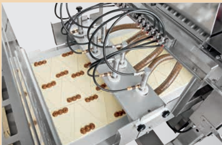
Manifold pour une application décalée et ajout de rangées supplémentaires
