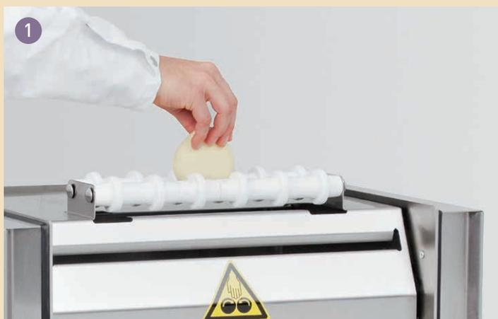
1. Ajuste la abertura de los cilindros al espesor deseado para la primera y la segunda pasada.
