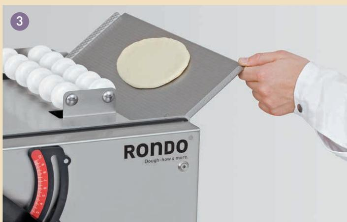
3. Gire ahora 90° la pieza de masa oval y vuelque la placa de alimentación. Los cilindros se ajustan automáticamente y simultáneamente al espesor preseleccionado para la segunda pasada, y la masa es laminada otra vez.
