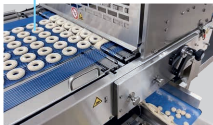
4 Rimozione automatica degli sfridi
