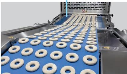
5 Высокая точность укладки заготовок в расстоечный шкаф
