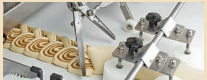
Accesorios especiales, por ejemplo, para la elaboración de productos en forma de cizalla
