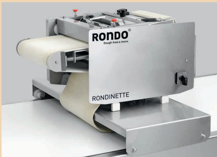
Рациональное производство круассанов Вы производите и круассаны? В таком случае вам известно: их скручивание вручную отнимает много времени. При помощи нашего устройства Rondinette для скручивания круассанов вы сможете быстро и эффективно производить круассаны самых разных размеров. Нарезанные треугольниками на столе для нарезки или на тестораскаточной машине Cutomat тестовые заготовки просто укладывают на подающий транспортер Rondinette и неплотно скручивают.
