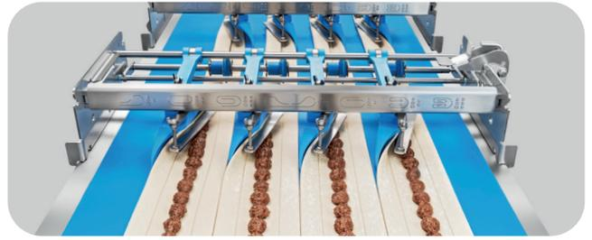
La lámina de masa se pliega dos veces con una estación de plegado de una o varias filas. El pliegue de cierre se sitúa encima o debajo del producto final, según sus necesidades.
