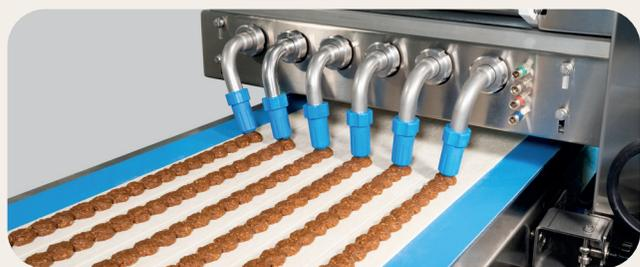
De forma continua, discontinua o por puntos: los rellenos, desde suaves y cremosos hasta sólidos, se colocan sobre la lámina de masa en una a seis filas.
