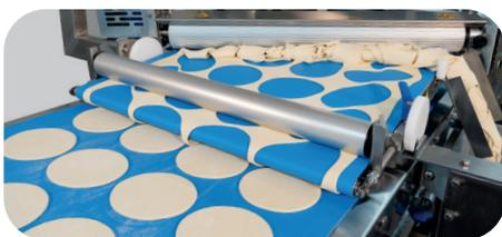
Los recortes de masa se retiran automáticamente de la cinta transportadora. Este proceso prepara sus productos para el depositado automático o la transferencia a otra máquina.
