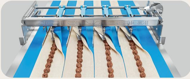
La lámina de masa se pliega una vez con una estación de plegado de una o varias filas. Después se corta a la longitud deseada ...
