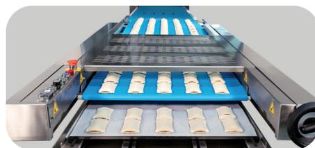
Una sola persona puede manejar la depositadora compacta de RONDO. Permite el depositado automático de sus productos de panadería antes de transferirlos para reposar u hornear.
