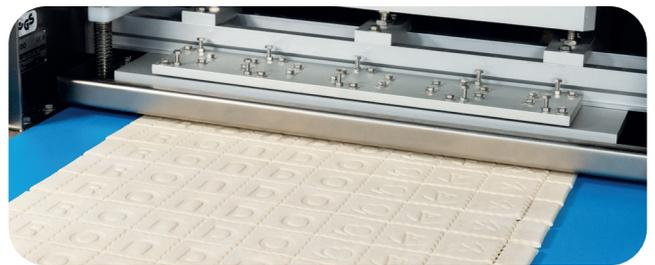
La lámina de masa se puede troquelar con una gran variedad de formas. Los troqueles pueden fabricarse a medida según sus necesidades.
