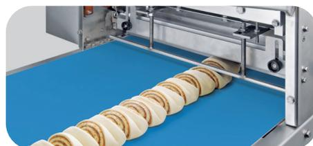
Durante el corte, los rollos de canela pueden gofrarse con una matriz de troquelado especial.
