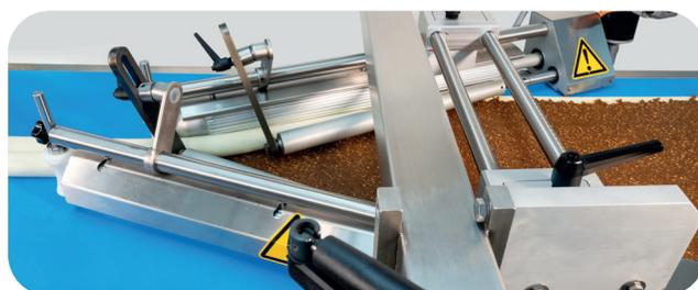
La unidad de enrollado doble permite fabricar rollos dobles especiales. La lámina de masa se enrolla desde ambos lados.
